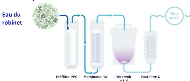
**Le préfiltre PPC** : Notre préfiltre deux-en-un, de très haute qualité, associe des billes de polypropylène et du charbon actif. Il retient la rouille, le limon, les bactéries, le chlore résiduel et son odeur, et les pesticides jusqu'à 0,001  $\mu\text{m}$ . Sa durée de vie est d'environ 6 mois\*.
